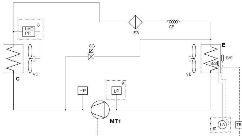
Der Kompressor (MT1) verdichtet das Kühlgas und bringt es auf einen hohen Druck und eine hohe Temperatur.
