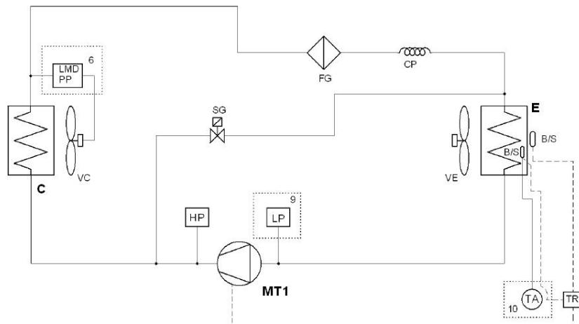
Il compressore (MT1) comprime il gas frigorigeno, portandolo ad una alta pressione e temperatura;
