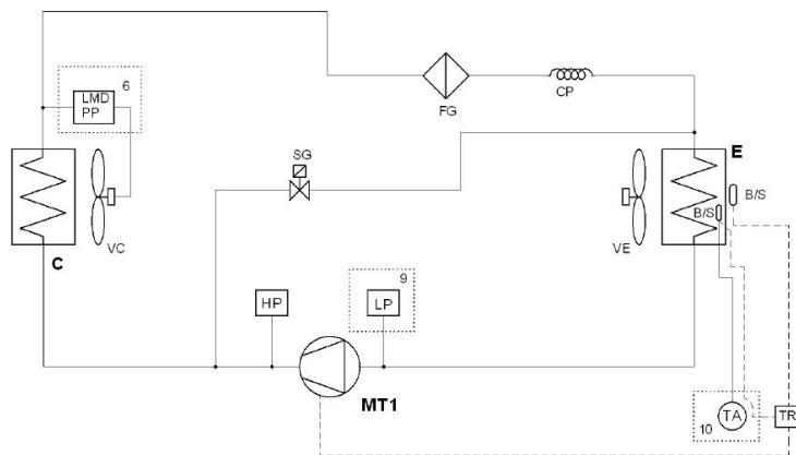
El compresor (MT1) comprime al gas refrigerante, llevándolo a una alta presión y temperatura;
