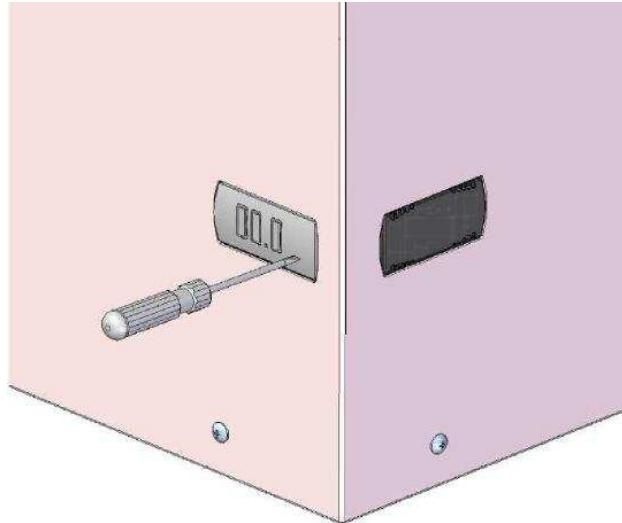
*Togliere la cover del termostato e ruotare le 2 viti in senso antiorario con l'ausilio di un cacciavite Remove the cover of the thermostat and turn the 2 screws counterclockwise with a screwdriver Die Thermostatabdeckung entfernen und die beiden Schrauben mit Hilfe eines Schraubenziehers gegen den Uhrzeigersinn drehen*
