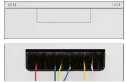
■ Herausbrechbare Verblendungen Die Kabeleinführungen im hinteren Teil des Verteilers sind mit herausbrechbaren Blenden versehen. Die Kabel können mit der Bürstenleiste gegen Staub abgedichtet werden. Der Kantenschutz dient zum Schutz der Kabel vor Beschädigung (Beides ist Bestandteil des Beipacks.).
