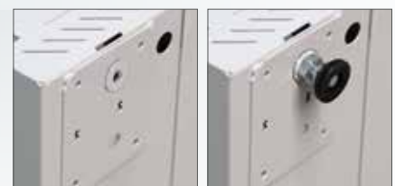
■ Nivellierfüße Links Vorbereitung für die Montage von Rollen oder Nivellierfüßen. Rechts installierter Nivellierfuß. Die Nivellierfüße sind Bestandteil des Schrankbeipacks.
